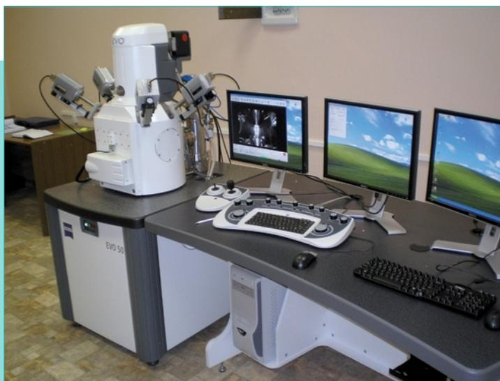
*Сканирующий электронный микроскоп
