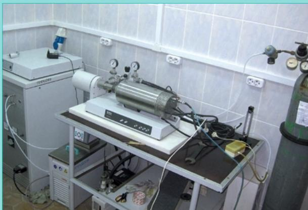
*Лазерный анализатор размера частиц Analyzette-22 Comfort*
