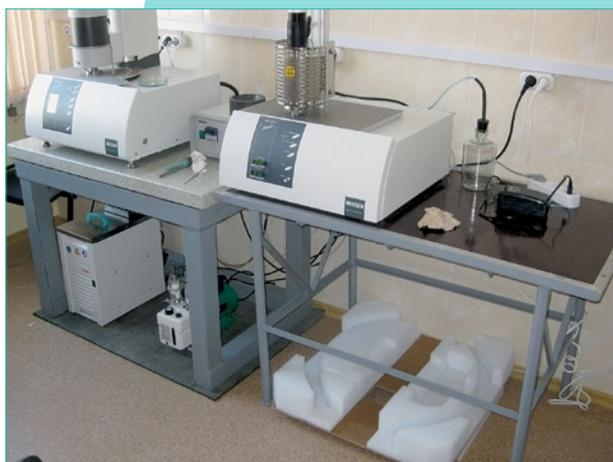
*Прибор синхронного термического анализа STA 449 F3, совмещенный с масс-спектрометром QMS 403 C*
